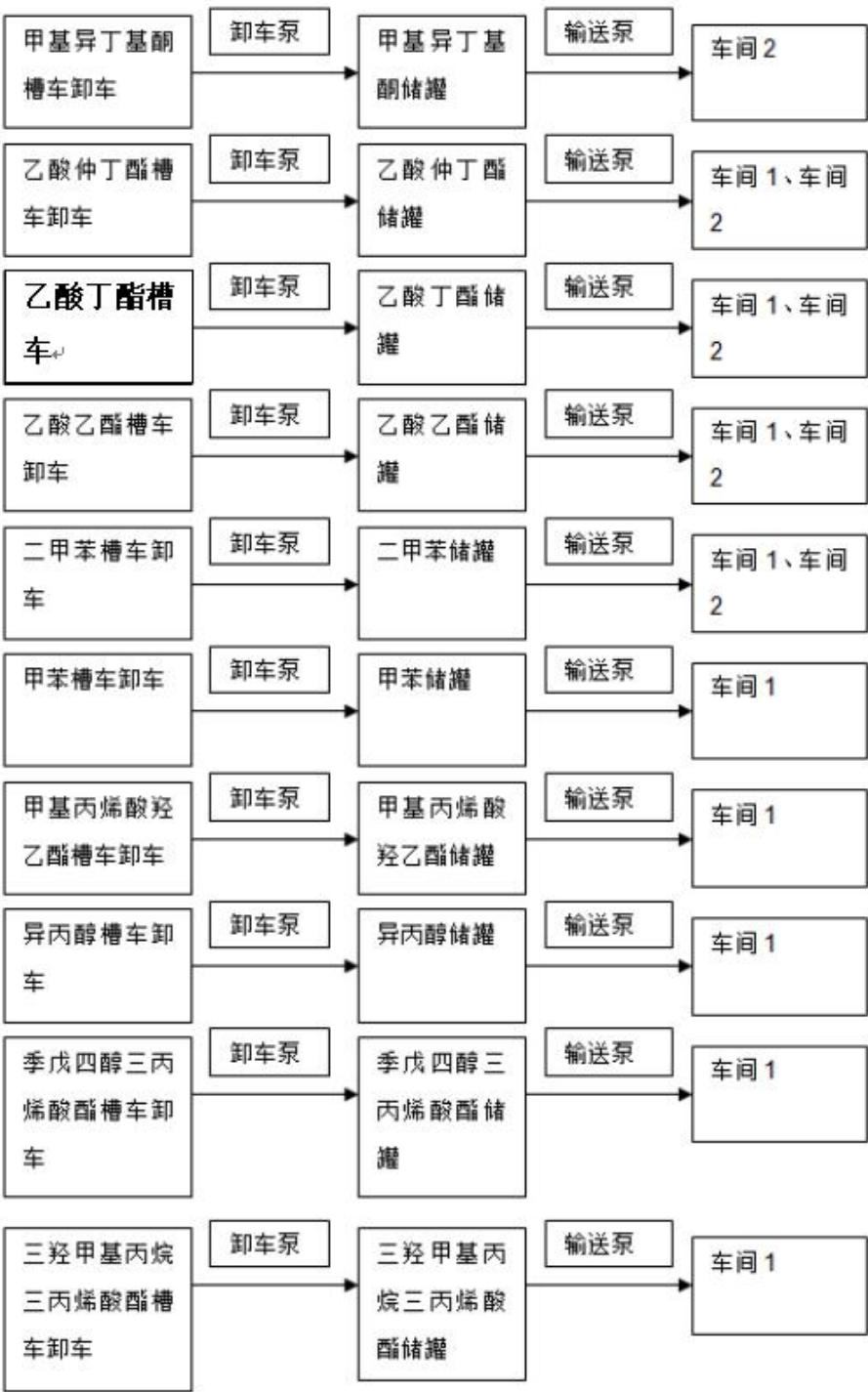
图 2.2-7 工厂储罐组工艺流程框图
